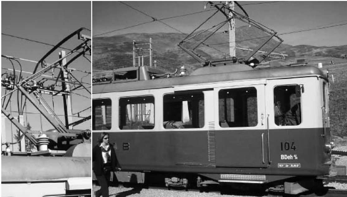
Jungfraubahn mit MO-Ableiter Typ POLIM-H 1.0 ND, montiert am Fuss des Pantografen des Triebfahrzeugs.
